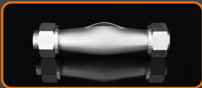
Durch **sichere Montage** wird das Rohr zum schwächsten Glied - dies beugt schwere Unfälle vor.
