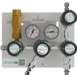
Type MPLHOXSPSU Option PS HD Spülventil ND Absperrventil (Prozessgasspülung im Eingang | Absperrventil im Ausgang) Zusatz U Rückschlagsventil im Eingang Sicherheitsventil im Ausgang
